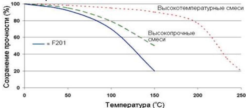
Уменьшение прочности обратно пропорционально охлаждению при условии, что место соединения не перегружено. Кратковременное воздействие более высоких температур может быть приемлемо.
